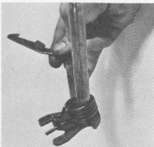
Shift lever return spring on shift arm
